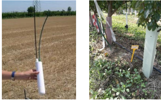
Fig. 22 – Lisimetro a suzione: conformazione (sx) e suo utilizzo in campo (dx).
