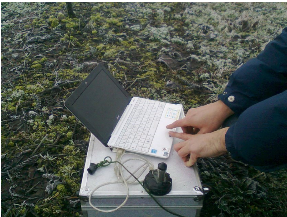
Figura 9: Scarico dati dal Diver
