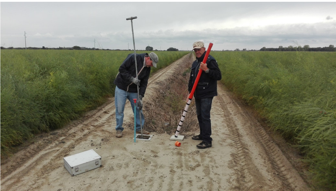
Figura 17: Posizionamento di un piezometro in pozzetto nel sito di Valle Gaffaro.
