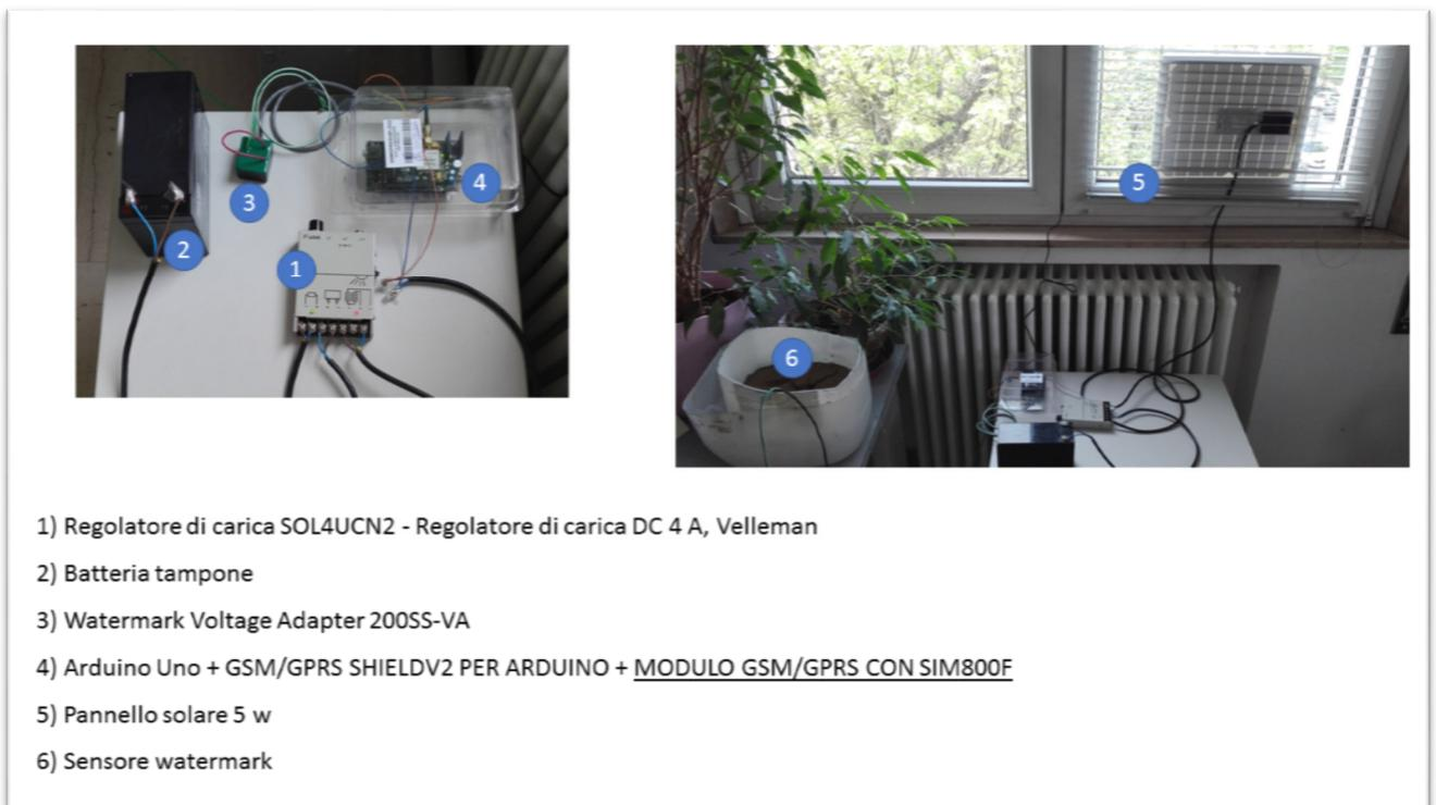
Figura 30: immagine del sistema sviluppato e di tutte le sue componenti
