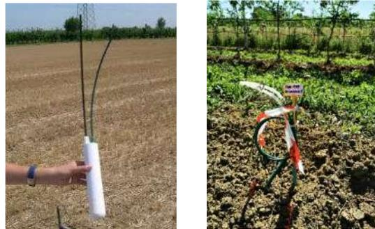
Fig. 16 – Lisimetro a suzione: conformazione (sx) e suo utilizzo in campo (dx).
