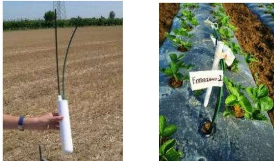
Fig. 14– Lisimetro a suzione: conformazione (sx) e suo posizionamento sulla coltura (dx).
