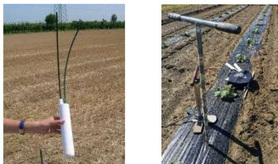
**Fig. 15– Lisimetro a suzione: conformazione (sx) e suo posizionamento sulla coltura (dx).**
